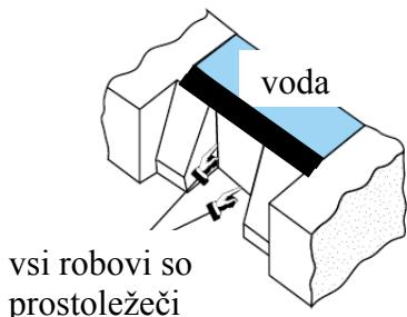
**3. naloga** (30 minut): Okno na sliki je narejeno iz dveh materialov: prozorne plastike in jekla. Po zunanjem robu je obremenjeno s silo  $2 \text{ kN/m}$ .
